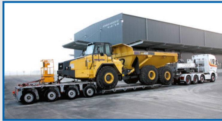
Der Tiefelader mit seinen 68 Tonnen Nutzlast befördert einen Dumper zum Einsatzort, wo das allradgetriebene Fahrzeug Abräumarbeiten ausführt.
